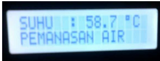
Gambar 4.5. Tampilan pengukuran temperatur akhir LM35.
