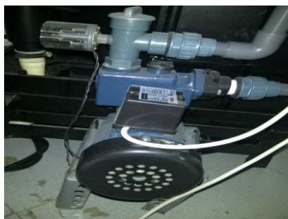
Gambar 4.7. Pompa Penyiraman air panas ke ampas tahu
