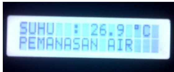
Gambar 4.4. Pendeteksian awal temperatur ruangan normal LM35
