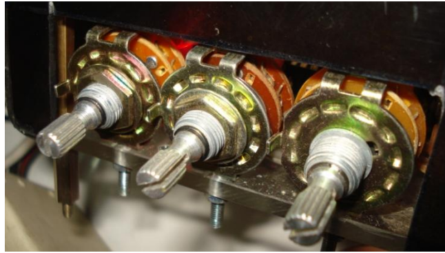
Gambar 4.21. Switch manual pada hardware
