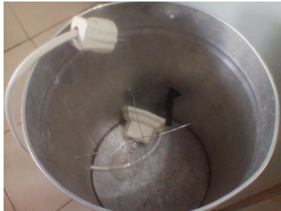
Gambar 3.6 Tabung dengan bohlam sebagai pemanas digester
