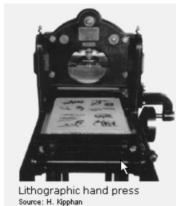
Gambar 3.1 mesin cetak yang menggunakan metode awal proses cetak ( Lithographic hand press ).
