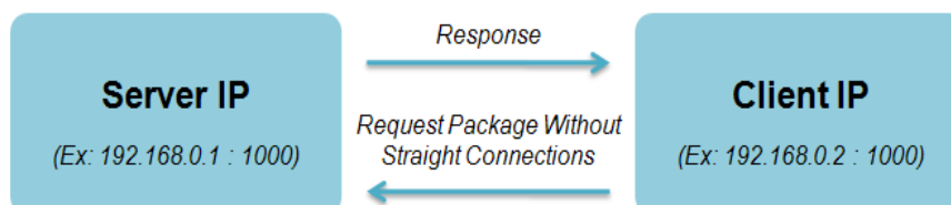
Gambar 2.7 Komunikasi Client-Server Dengan Socket Datagram
