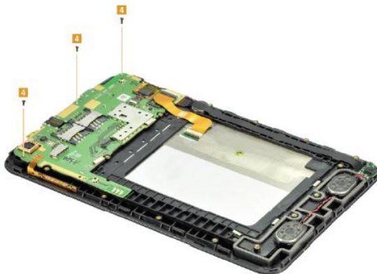
Gambar 4.47. Membuka Sekrup Mainboard
