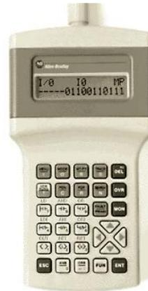
Gambar 3.11 Hand held programmer dari PLC Allen
