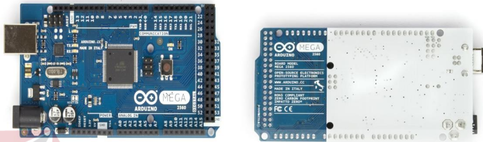
Gambar 2.4 Arduino Mega 2560 Sisi Depan (Kiri) dan Belakang(Kanan)
