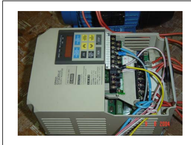
Gambar 3.7. Inverter Motor Tiga Fasa
