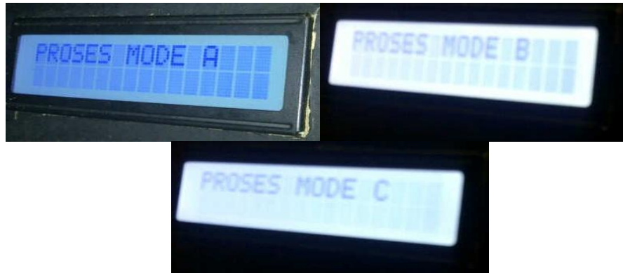
Gambar 4.2. Tampilan Tombol pemilihan modeA, modeB, dan modeC pada LCD.
