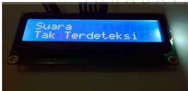
Gambar 4.6 Kondisi LCD ( Liquid Cristal Display ) Saat Suara Tidak Terdeteksi
