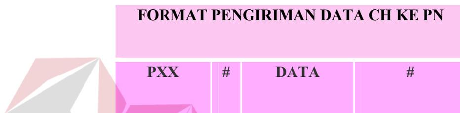
**Gambar 3.13** Format pengiriman data dari *Cluster Head* ke *Parent Node*
