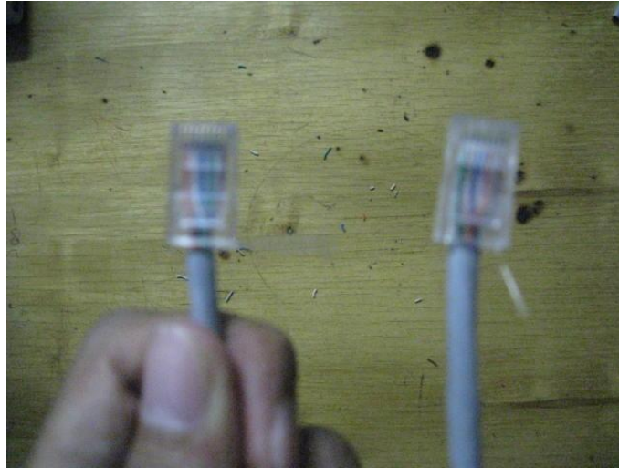
Gambar 2.36 P1 dan P2 kabel UTP dengan crossover proses sudah selesai
