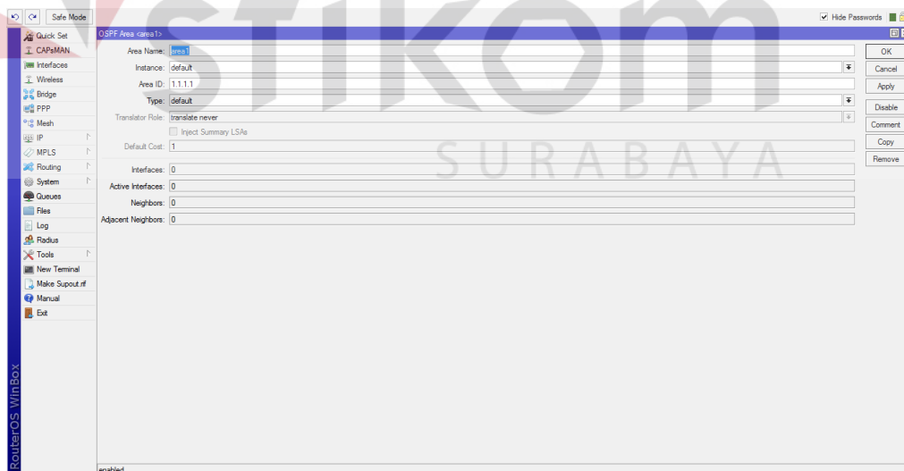
Gambar 4.46 konfigurasi OSPF pada R2 area 1
