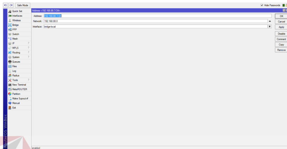
Gambar 4.15 konfigurasi address R1 (3)
