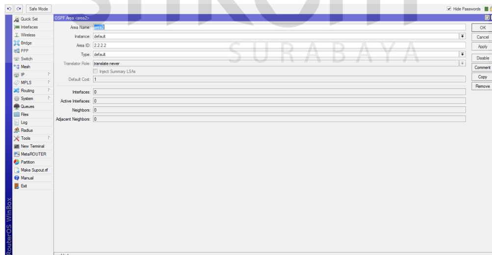
Gambar 4.33 konfigurasi OSPF pada R1 area 2
