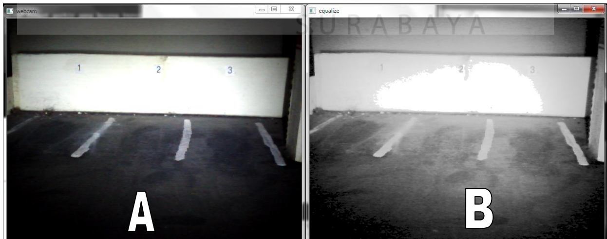
Gambar 4.15. Gambar A sebelum diperbaiki dan gambar B sesudah diperbaiki dengan intensitas 80 lux
