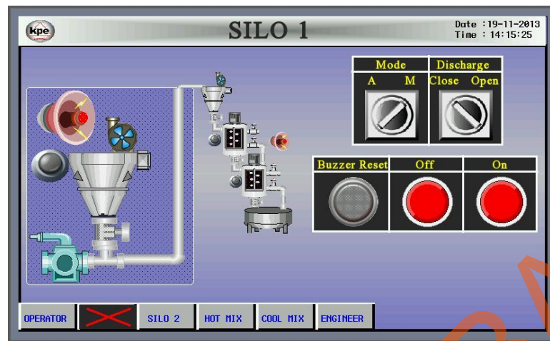
Gambar 4.7 Mesin automatic mixing pada silo 1 mode auto.
