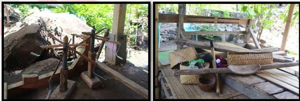
Gambar 4.2 Alat tenun proses tenun ikat (Sumber: Peneliti 2015)
