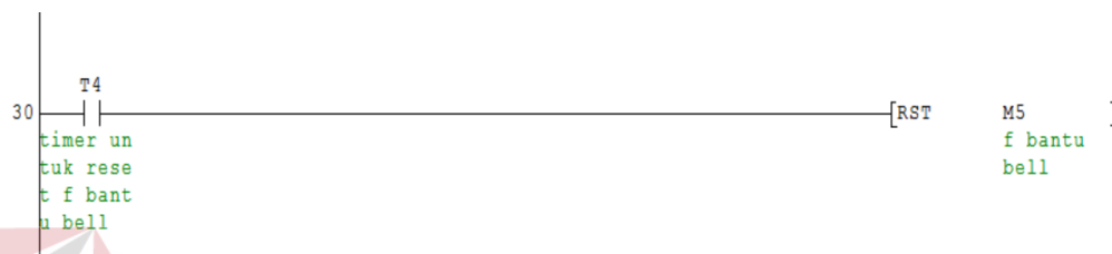
Gambar 4. 14 Ladder Diagram Pada Rung Ketujuh
