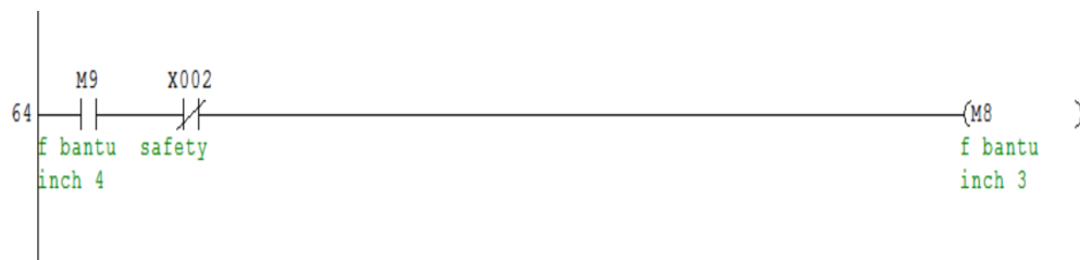
Gambar 4. 20 Ladder Diagram Pada Rung Ketiga Belas
