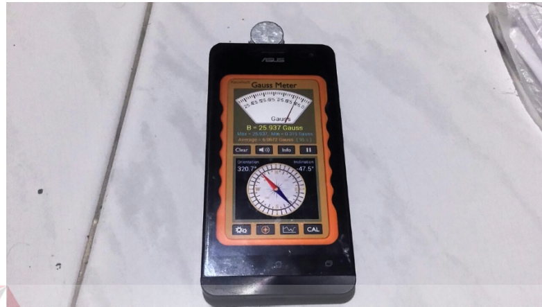
Gambar 4.8 Hasil Kuat Medan Magnet Neodymium Dengan Sisi 2-2
