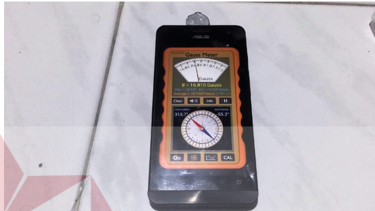
Gambar 4.4 Hasil Kuat Medan Magnet Neodymium Dengan Sisi 1-1
