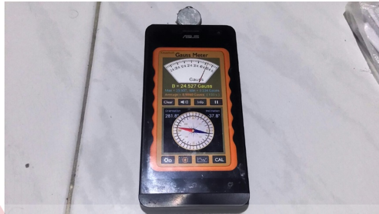
Gambar 4.6 Hasil Kuat Medan Magnet Neodymium Dengan Sisi 2-1
