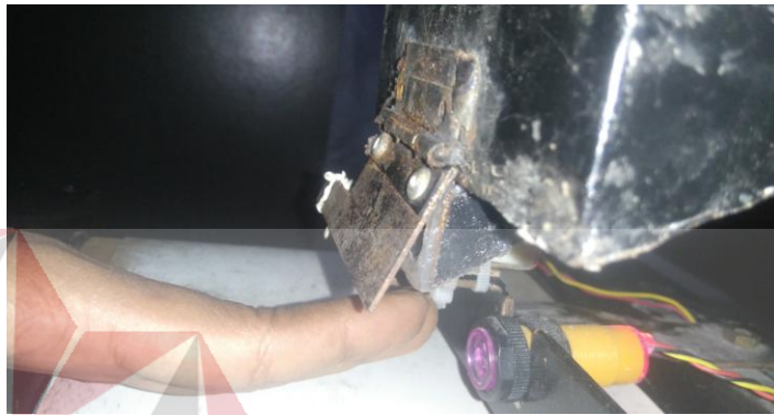
Gambar 4.8 Hasil pengujian ketika sensor di beri halangan
