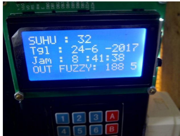
Gambar 4.6 Pengujian pada Sensor LM35
