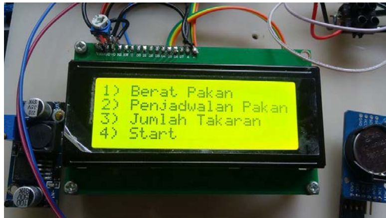
Gambar 3.7 Tampilan menu pada LCD 20x4
