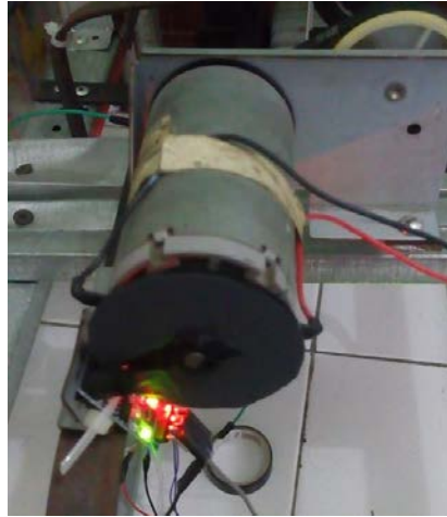
Gambar 4.10 Sensor Rotary mendeteksi satu putaran
