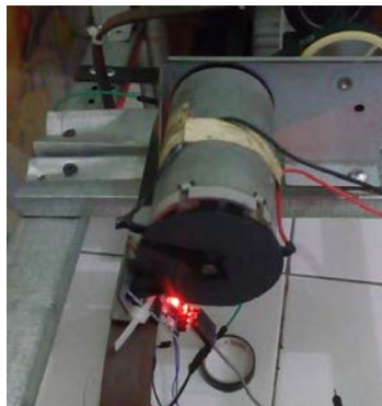
Gambar 4.9 Sensor Rotary saat belum mendeteksi satu putaran
