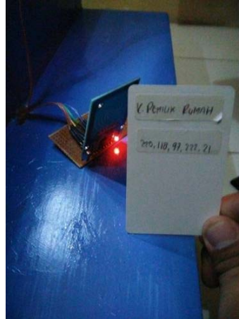
Gambar 4.1 Pengujian kartu RFID pemilik utama.
