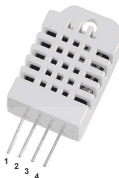
Gambar 2.9 Konfigurasi pin Sensor Kelembaban dan suhu DHT22
