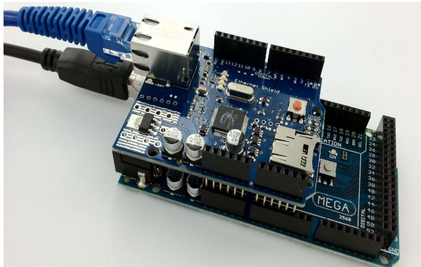
Gambar 3.11 Rangkaian Arduino Mega dengan Ethernet Shield
