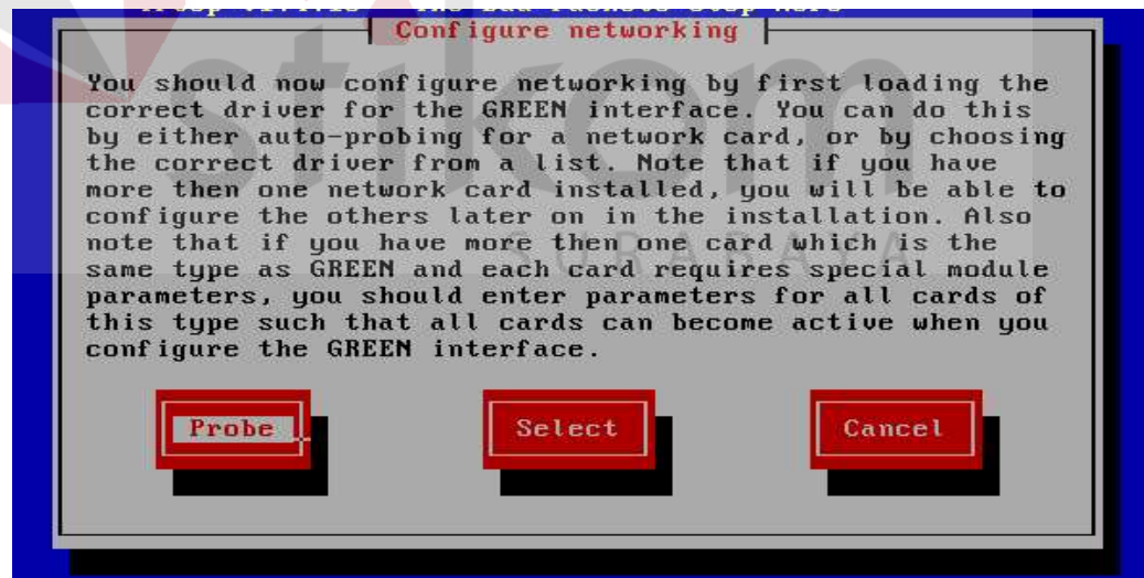
Gambar 4.9. Konfigurasi Jaringan untuk Kartu Jaringan Green
