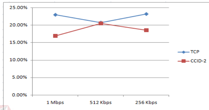
Gambar 4.1 Utilisasi Bandwidth untuk percobaan protocol TCP dengan DCCP CCID-2 Saat TCP Berjalan Lebih Dahulu
