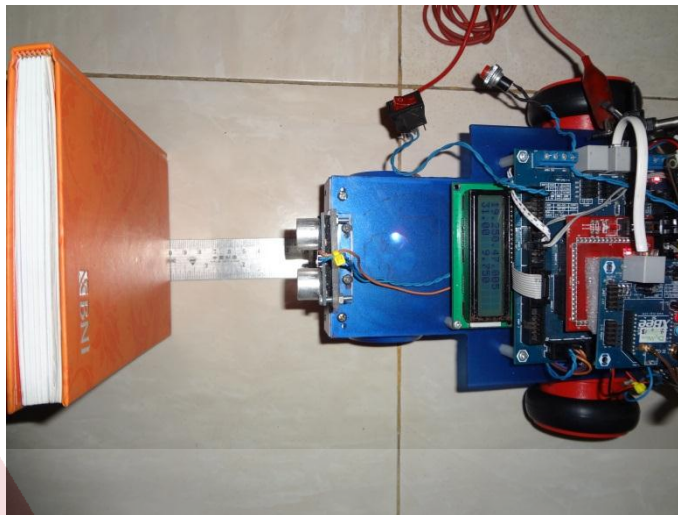
Gambar 4.3 Cara Pengujian Sensor Ultrasonik
