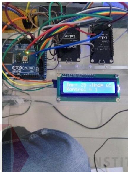
Gambar 4. 7 Tampilan LCD Pengujian Pengiriman Data ke Aplikasi Android
