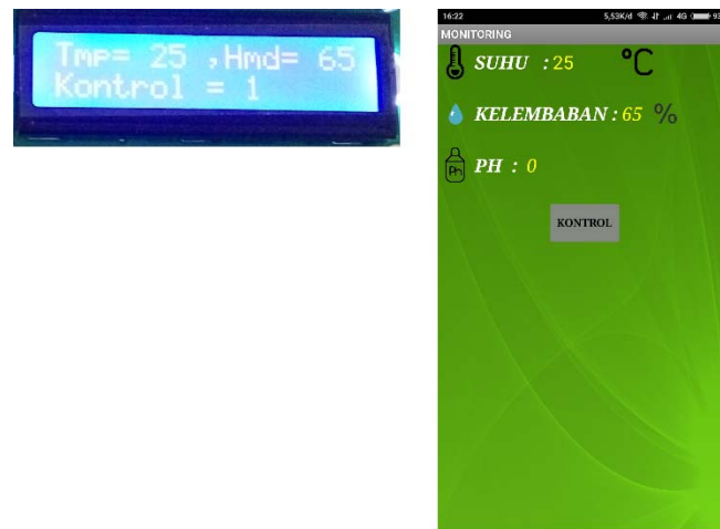
Gambar 4. 10 Perbandingan Data LCD dengan Aplikasi Android
