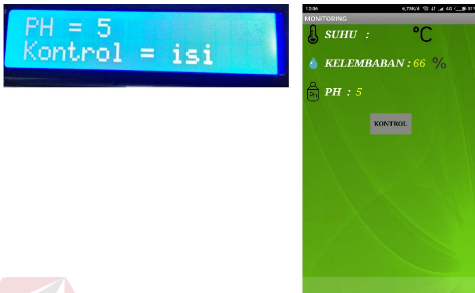
Gambar 4. 16 Perbandingan Data LCD Dengan Aplikasi Android
