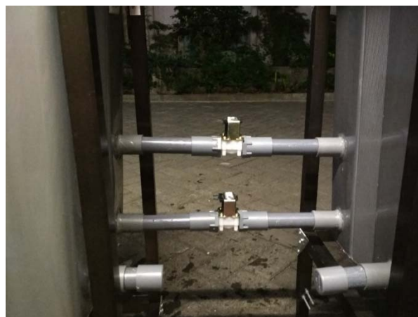
Gambar 3. 13 Pemodelan Pintu Air Menggunakan Solenoid valve
