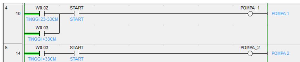
Gambar 4. 18 Program Mengaktifkan Output Pompa
