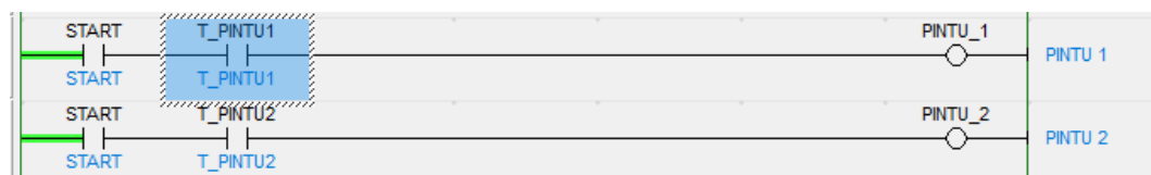
Gambar 4. 22 Program untuk Mengaktifkan Solenoid Valve
