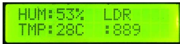
Gambar 4. 10 Hasil Pengujian LCD 16x2
