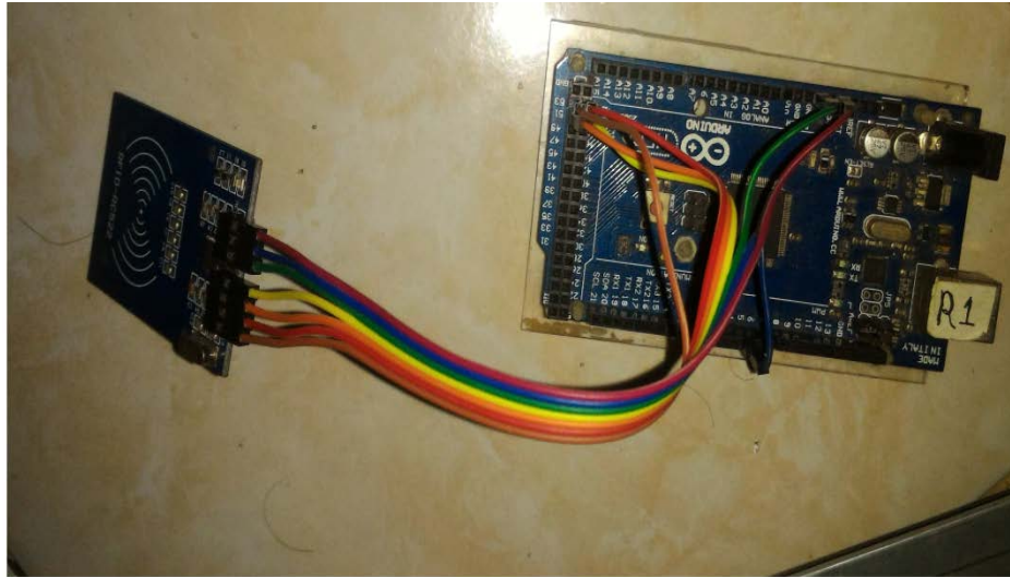
Gambar 3.10 foto RFID reader saat disambungkan pada Arduino Mega
