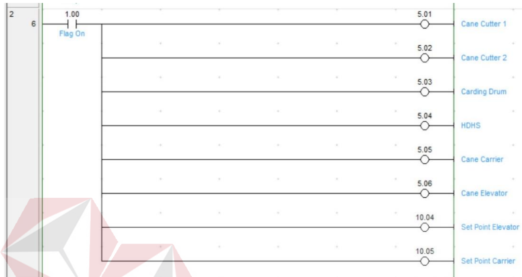
Gambar 4.7 Diagram Ladder Untuk Menyalakan Daya
