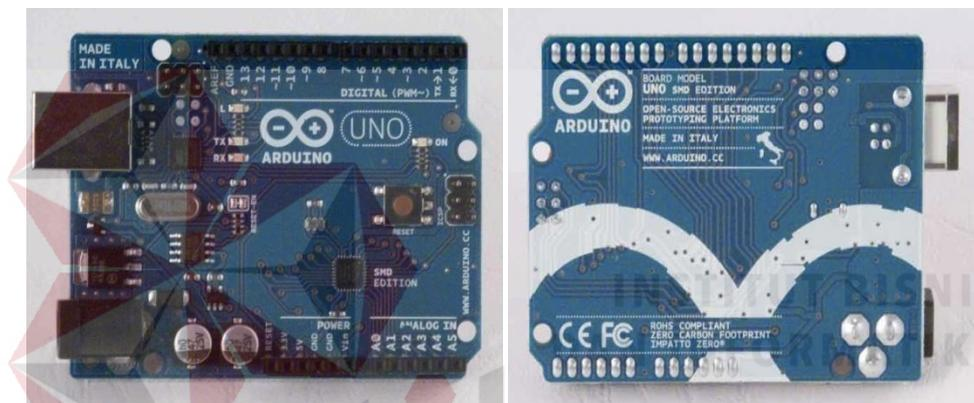
**Gambar 2.3** Arduino Uno SMD R3 Sisi Depan (Kiri) dan Belakang(Kanan)
