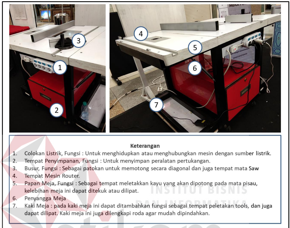
Gambar 4 .15 Detail Fungsi Penerapan Sistem Produk
