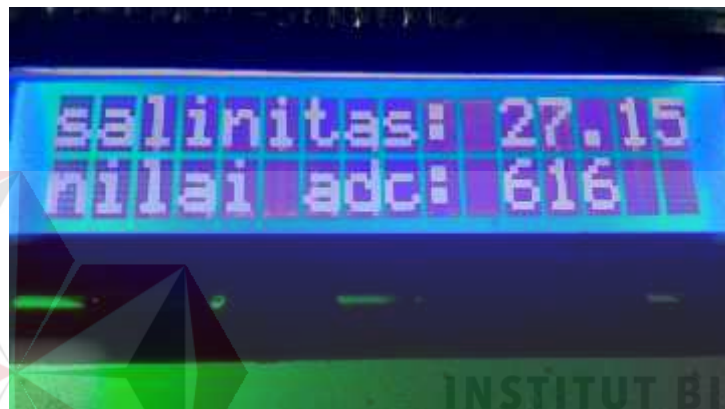
Gambar 4.2 Pengujian sensor salinitas pada larutan garam 27 ppt
