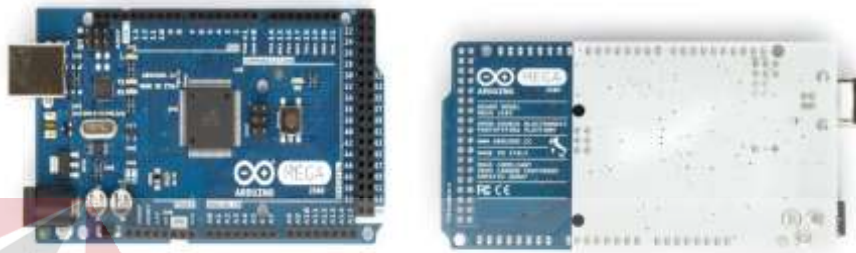
Gambar 2.1 Arduino Mega 2560 Sisi Depan (Kiri) dan Belakang (Kanan)
