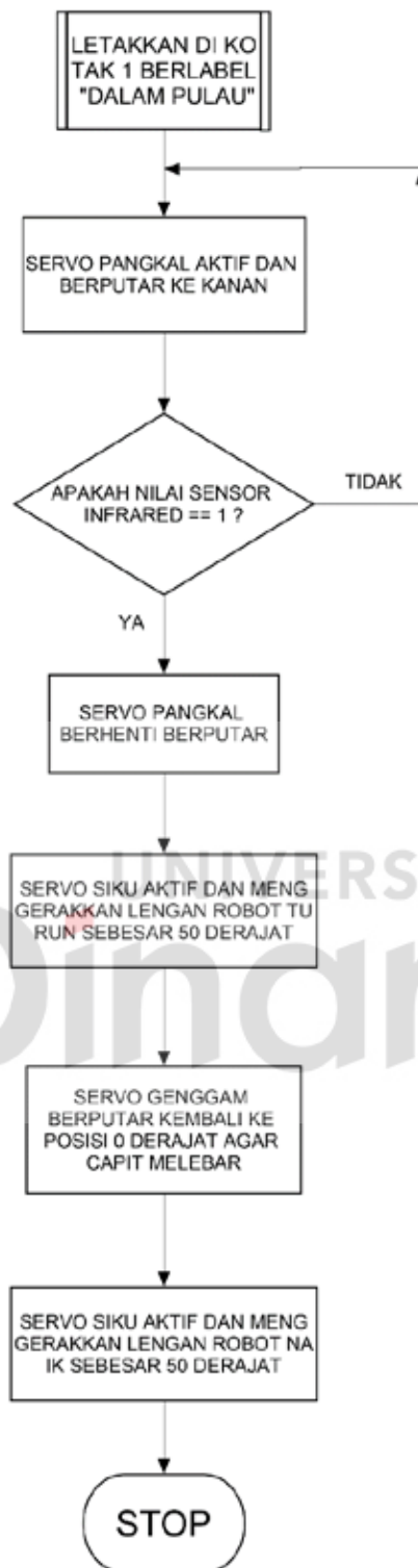
Gambar 3.12 Flowchart Program Sub Proses Letakkan Di Kotak 1 Berlabel "Dalam Pulau"
