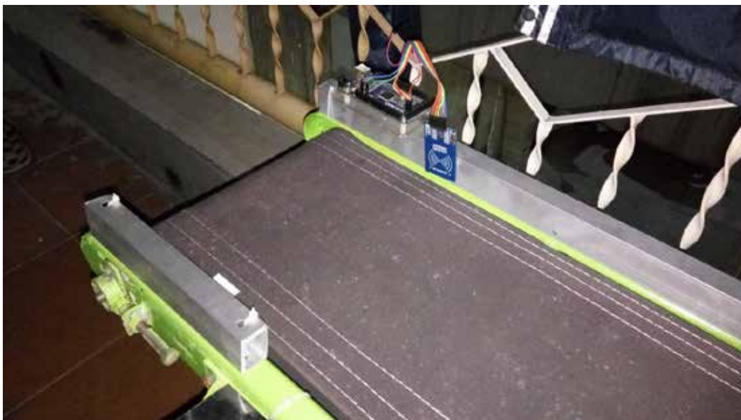
Gambar 3.6 RFID Pada Sistem Konveyor Yang Telah Ada
