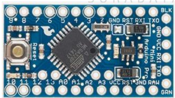
Gambar 2. 2 Arduino Pro Mini dan Pemetaan Pinnya (Sumber : https://www.arduino.cc )
