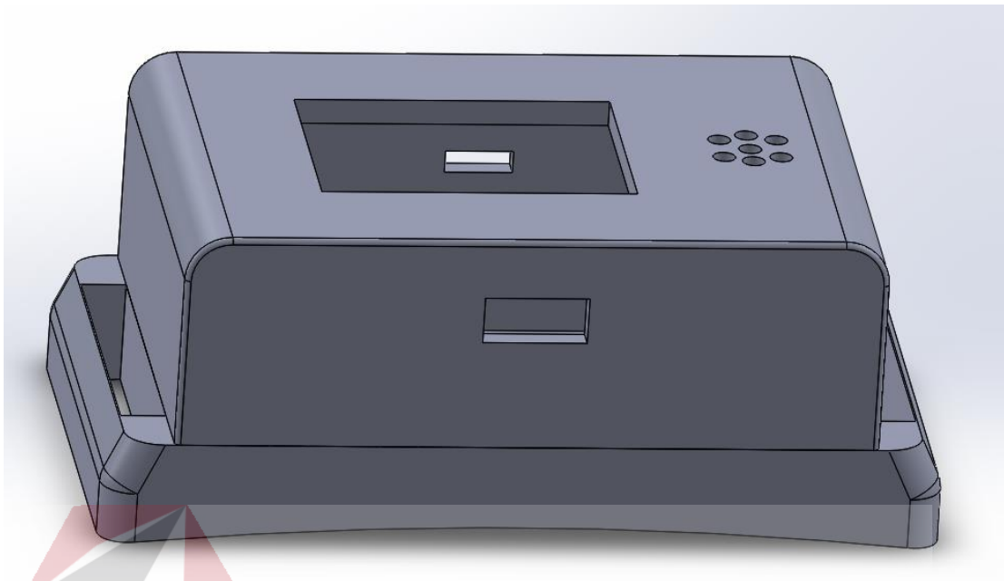
Gambar 3.13 Desain Casing Perangkat Keras
