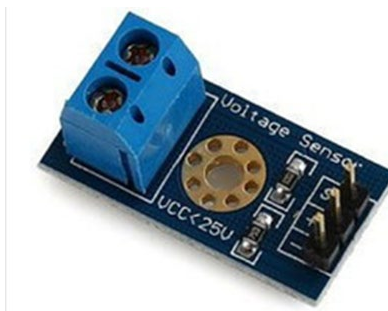
Gambar 2.10 Modul Sensor Tegangan
