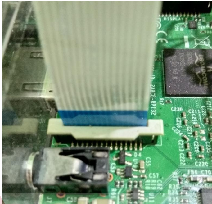
Gambar 4.4 Pemasangan Pi Camera ke Raspberry Pi
