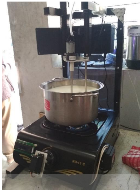
Gambar 3.19 Rancang bangun otomatisasi pasteurisasi tampak samping
