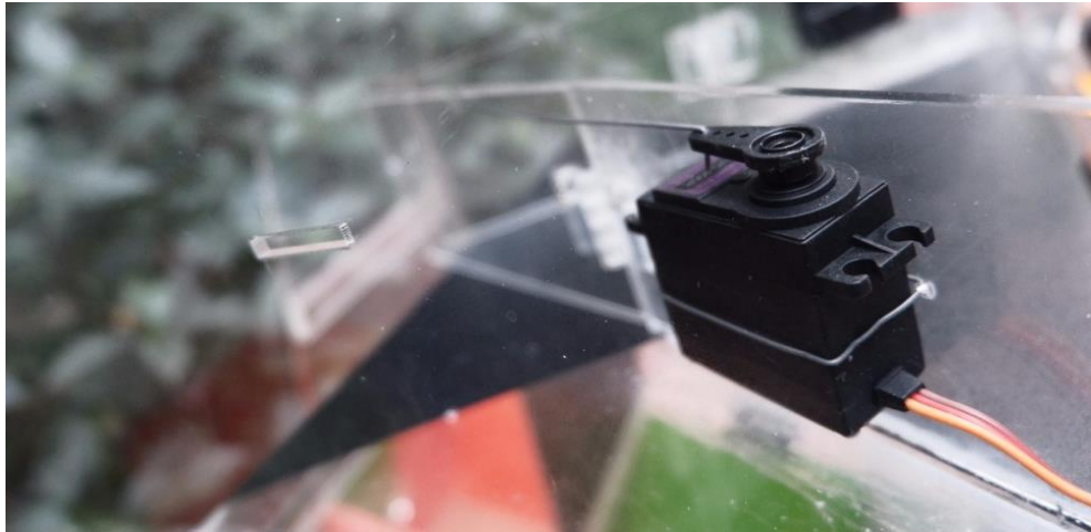
Gambar 3. 18 Mekanik Servo Lengan Pintu Tempat Sampah
