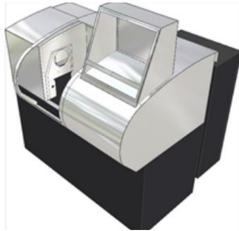
Gambar 3.8. Frame Mesin CNC Edulathe (Bagian Dalam Mesin Scanner )
