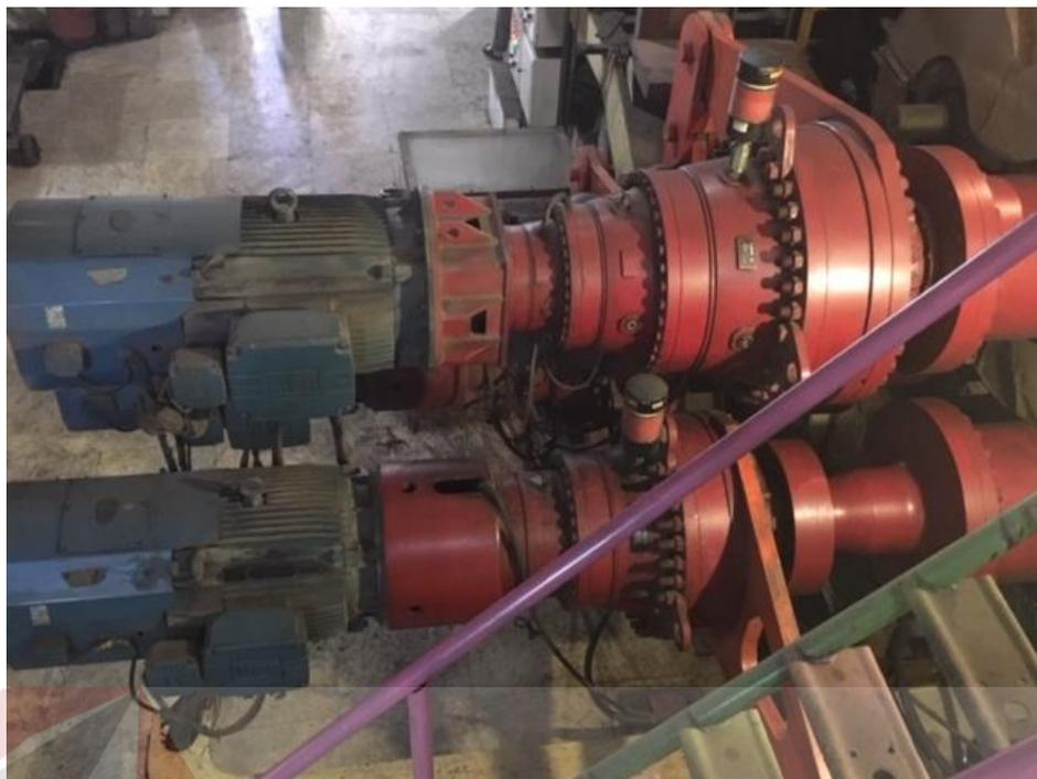
Gambar 4.16 Motor 3 fasa dan gearbox
