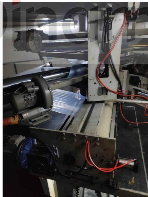
Gambar 4.28 Plastik yang sudah mulai memadat digulung
