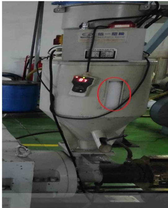
Gambar 4.22 biji plastik yang ditampung hopper
