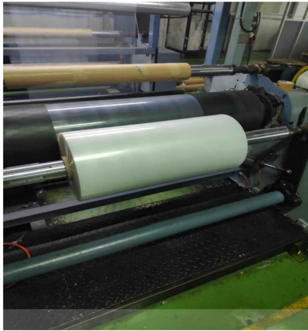
Gambar 4.32 rewinder yang melakukan penggulangan
