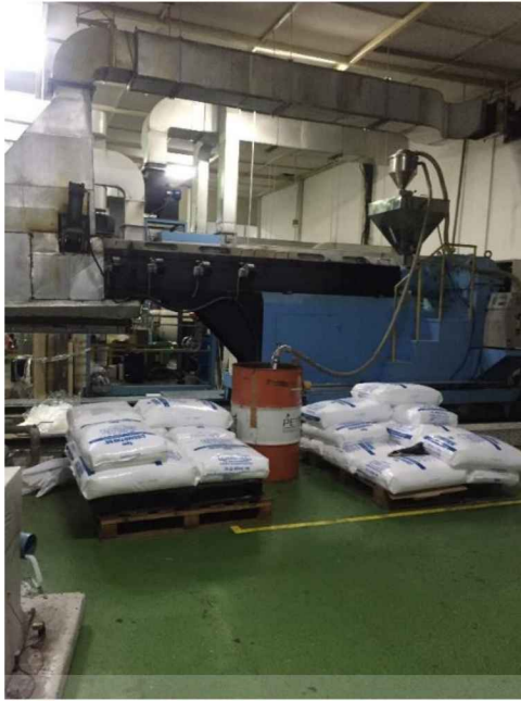
Gambar 4.4 biji plastik yang ditampung hopper
