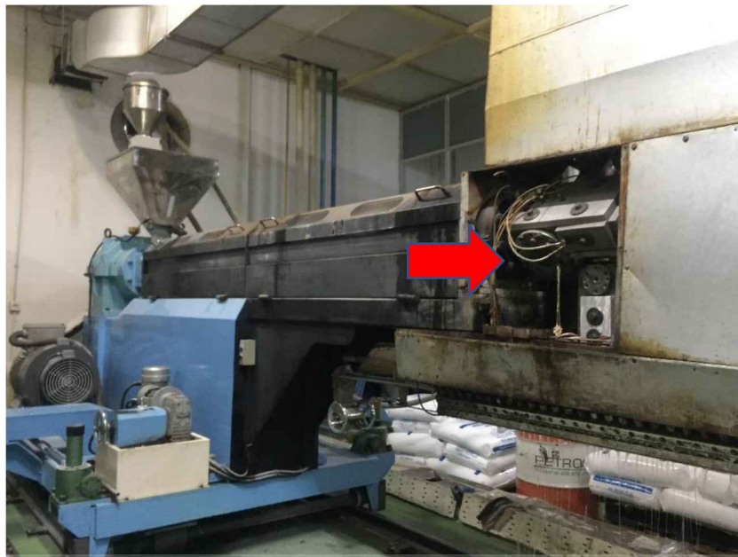
Gambar 4.6 plastik cair yang siap ditiupkan ke proses selanjutnya
