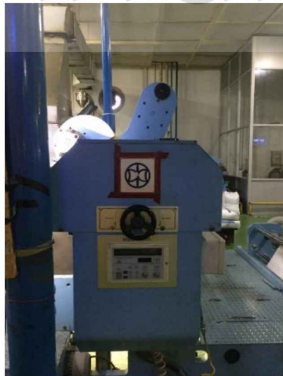
Gambar 4.7 corona pada mesin extrusion
