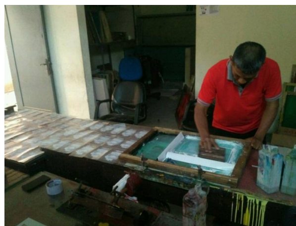
Gambar 2.5 Proses produksi kemasan dengan teknik sablon (Sumber: Hasil olahan penulis, 2019)
