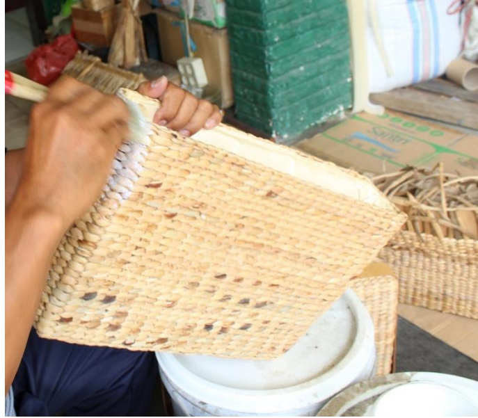
Gambar 4. 24 Pemberian Vernish Pada seluruh Bagian Tas (Sumber: Dokumentasi pribadi)
