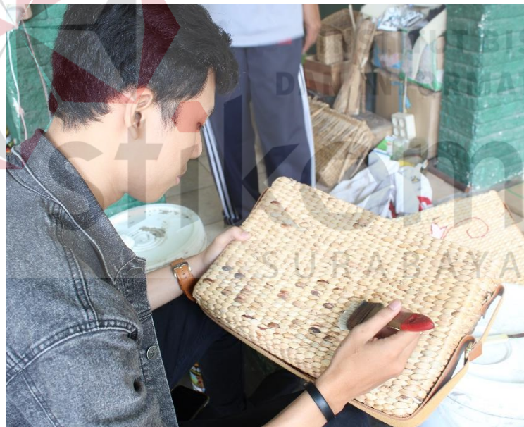
Gambar 4. 25 Pemberian Vernish pada seluruh bagian Tas (Sumber: Dokumentasi Pribadi)
